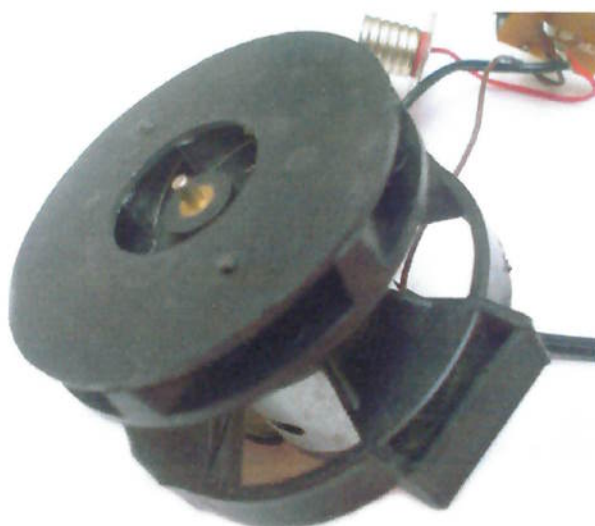
Figura 9.11 – Detalhe da ventoinha e suporte do motor
